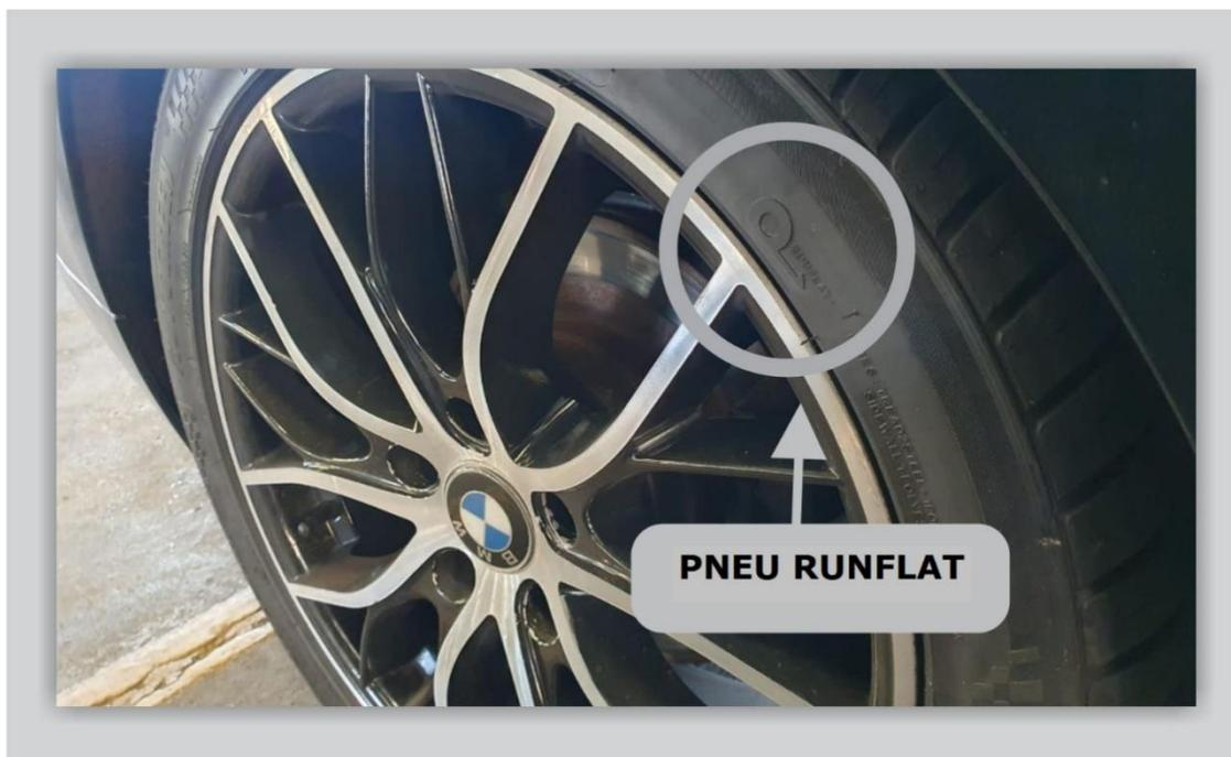
**Obs:** Para os veículos equipados com pneu runflat é indispensável o uso do Kit de reparação dos pneus.
