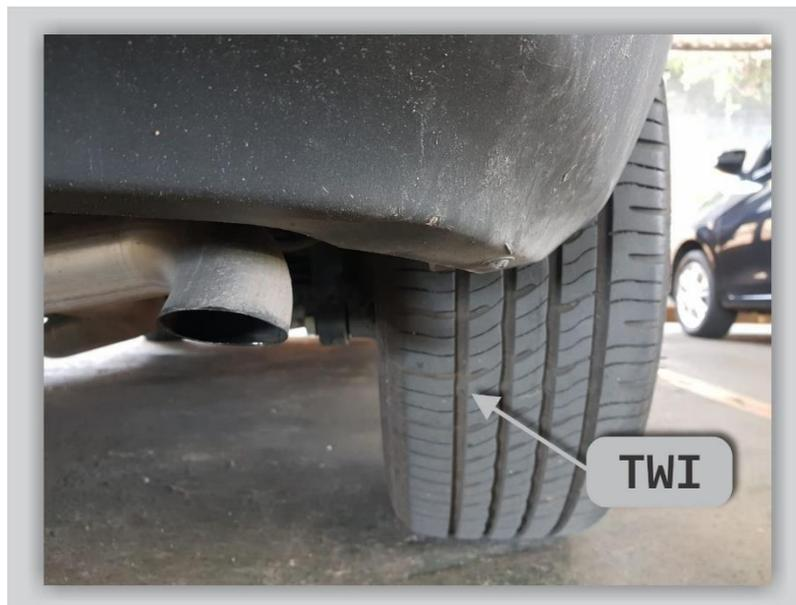
**j) 01 (uma) foto do pneu traseiro esquerdo mostrando a banda de rodagem e o TWI;**
